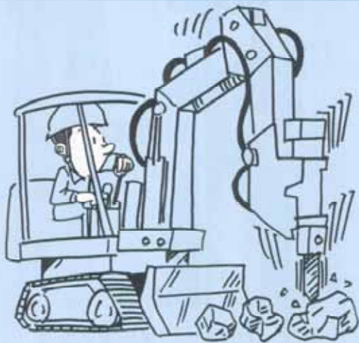
車両系建設機械を用いた掘削作業
