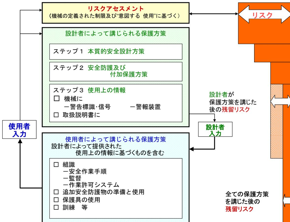
図 5-1 設計者の観点によるリスク低減プロセス (JIS B9700-1)
